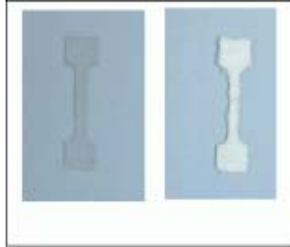
그림 13. PS-PnPMA 블록 공중합체(좌측)와 Kraton G1652 블록 공중합체의 압축성형(우측) 비교.
